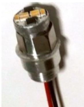
SUPPORTO CON LED 1,2W 24VDC TIPO G4 CON MOLLA DI TENUTA PER FORI D.11 MM
