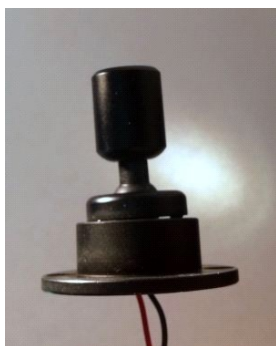
FARETTO SNODATO DIAMETRO BASETTA 37 MM ALTEZZA 42 MM DIAMETRO BICCHIERINO LED 14 MM POTENZA 1/2W ALIMENTAZIONE 8/26V DC COLORI STANDARD: NERO, ALLUMINIO
