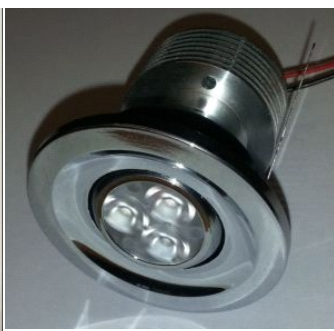
FARETTO INCASSO ORIENTABILE 3LED 1W/2W/3W ALIMENTAZIONE 13/26 VDC ANELLO DIAMETRO 45 MM FORO 40 MM LUNGHEZZA : 39/55 MM COLORI STANDARD: OTTONE BRUNITO, NERO, ALLUMINIO, CROMO
