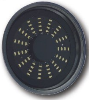
FARO LED DA PISCINA SOSTITUISCE NELLA SOLITA CASSAFORMA LA PAR 56 2500 OPPURE 5000 LUMEN ORDINABILE ANCHE IN VERSIONE RGB 12V IP68 Ref. ORION
