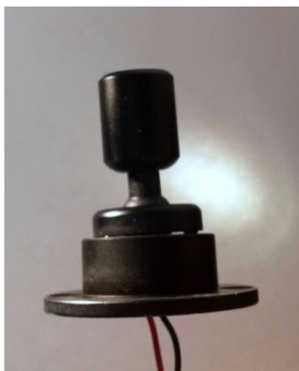
FARETTO SNODATO DIAMETRO BASETTA 37 MM ALTEZZA 42 MM DIAMETRO BICCHIERINO LED 14 MM POTENZA 1/2W ALIMENTAZIONE 8/26V DC COLORI STANDARD: NERO,ALLUMINIO
