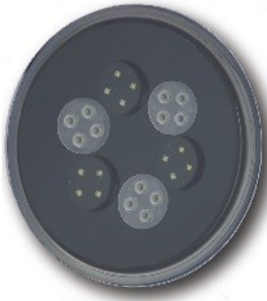
FARO LED DA PISCINA SOSTITUISCE NELLA SOLITA CASSAFORMA LA PAR 56 2500 OPPURE 5000 LUMEN ORDINABILE ANCHE IN VERSIONE RGB 12V IP68 Ref. ORION
